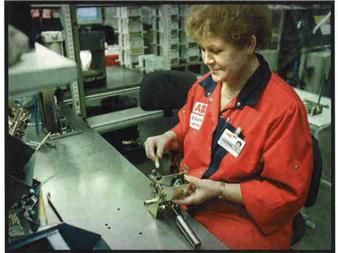
ABB Controlin kytkinvalmistuksessa työskentelevä Sinikka Rantala asentaa Scansolon valmistamaa akselia kytkimeen.
